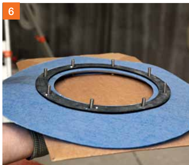
6 En de zelfgebouwde lijmfens is klaar om te worden ingebouwd.
