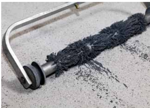
Afb.: Magneetrol voor het verzamelen van achtergebleven straalgoed
